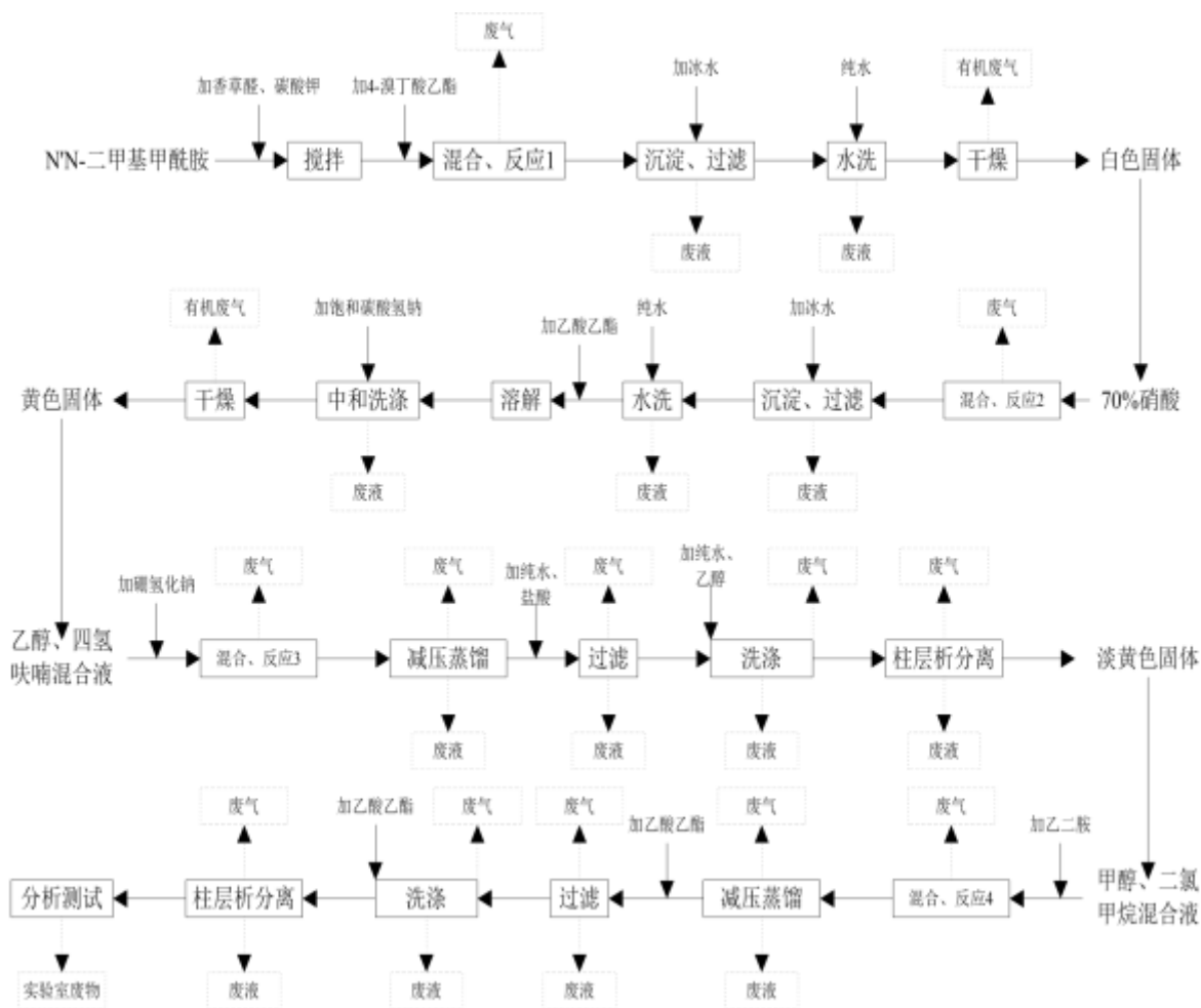
图 2-5 紫外光敏剂研发工艺流程及产污环节图
