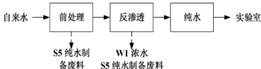
图 2-6 纯水制备工艺流程及产污节点图
