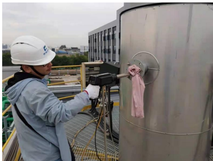
燃气锅炉废气排口
