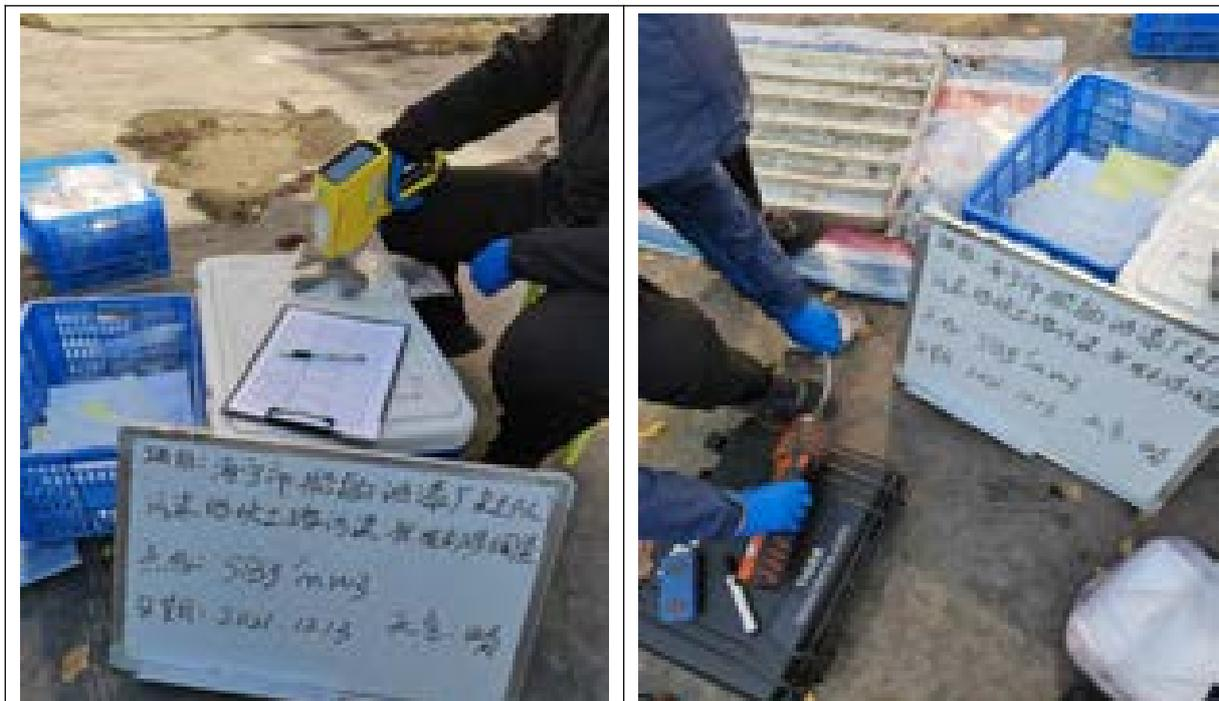
PID 和 XRF 现场快速筛查
