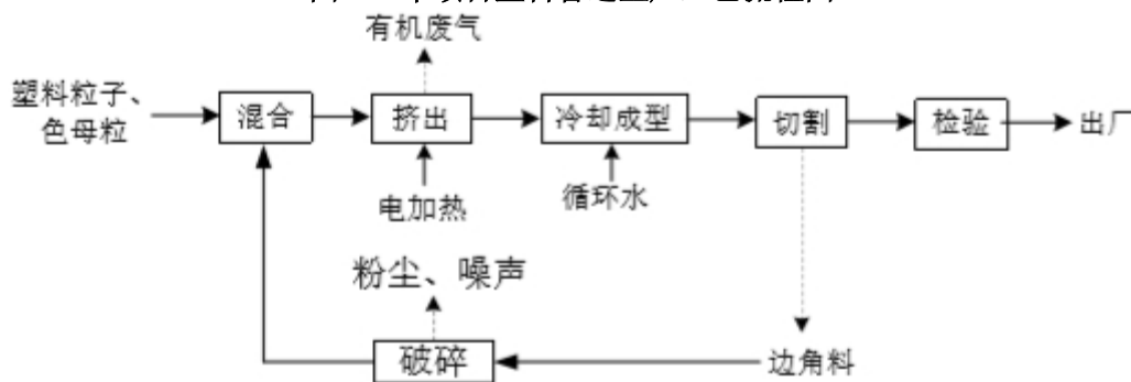
图 2-2 本项目塑料管道生产工艺流程图
