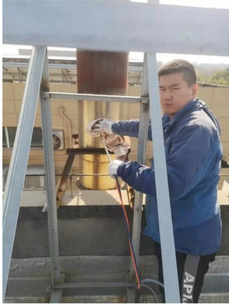
挂钩清理工艺废气检测
