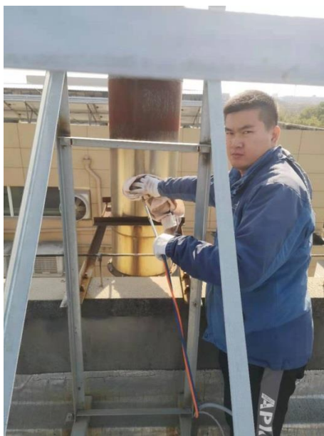
挂钩清理工艺废气检测
