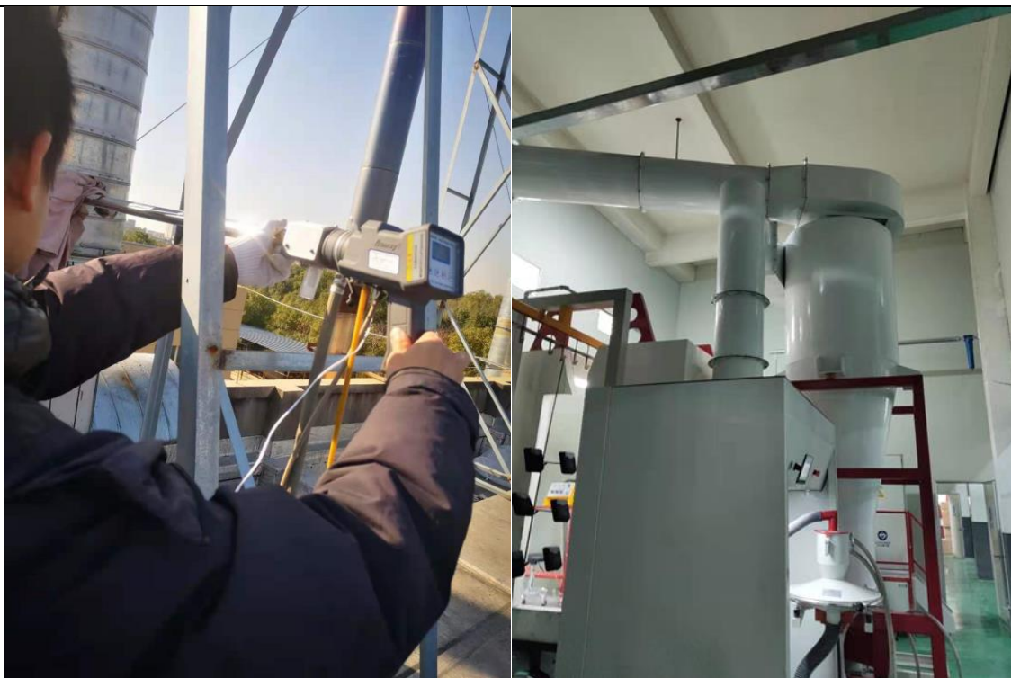
燃烧烘干工艺废气检测和喷塑工艺废气处理设施
