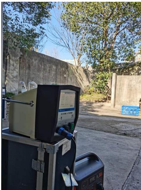
污水站无组织废气检测
