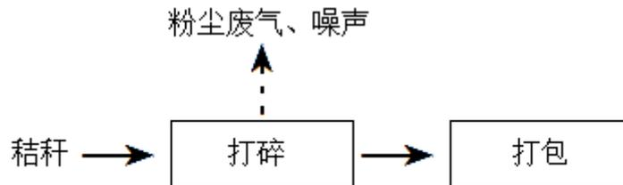
图 2-2 本项目生产工艺流程图及产污位置图
