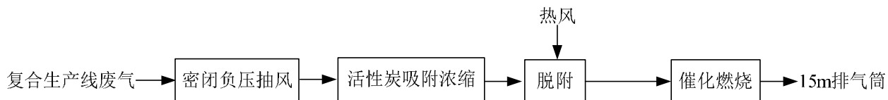
图 4-2 废气治理工艺流程图
