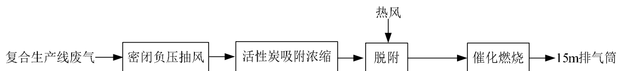
图 4-2 废气治理工艺流程图
