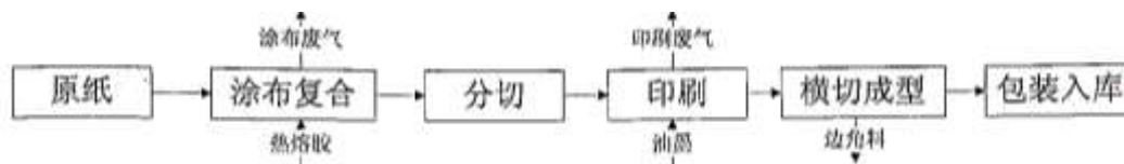
图 3-3 签纸生产工艺流程图及产污位置图
