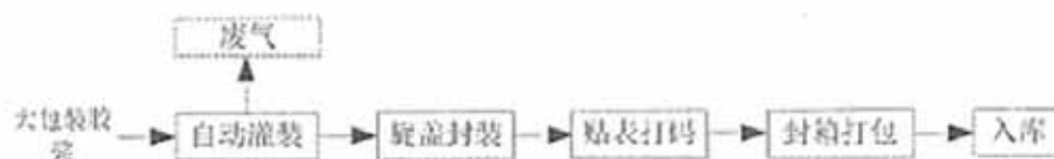
图 3-3 聚乙烯胶浆分装工艺流程图
