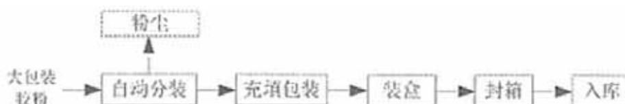
图 3-5 墙纸胶粉、熟胶粉分装工艺流程图
