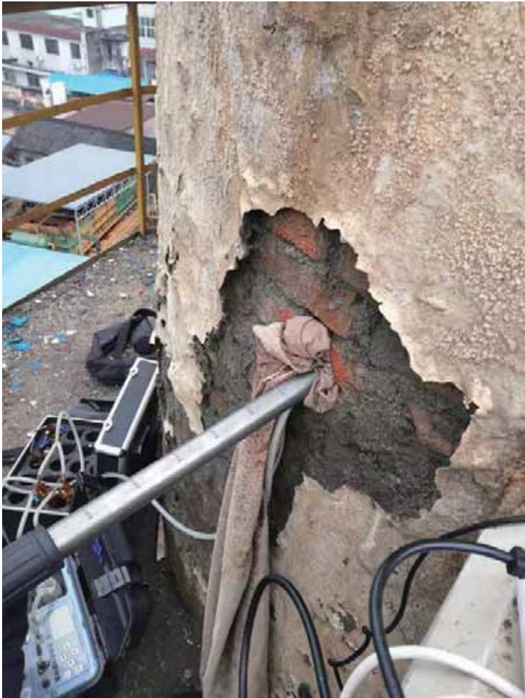
锅炉有组织采样
